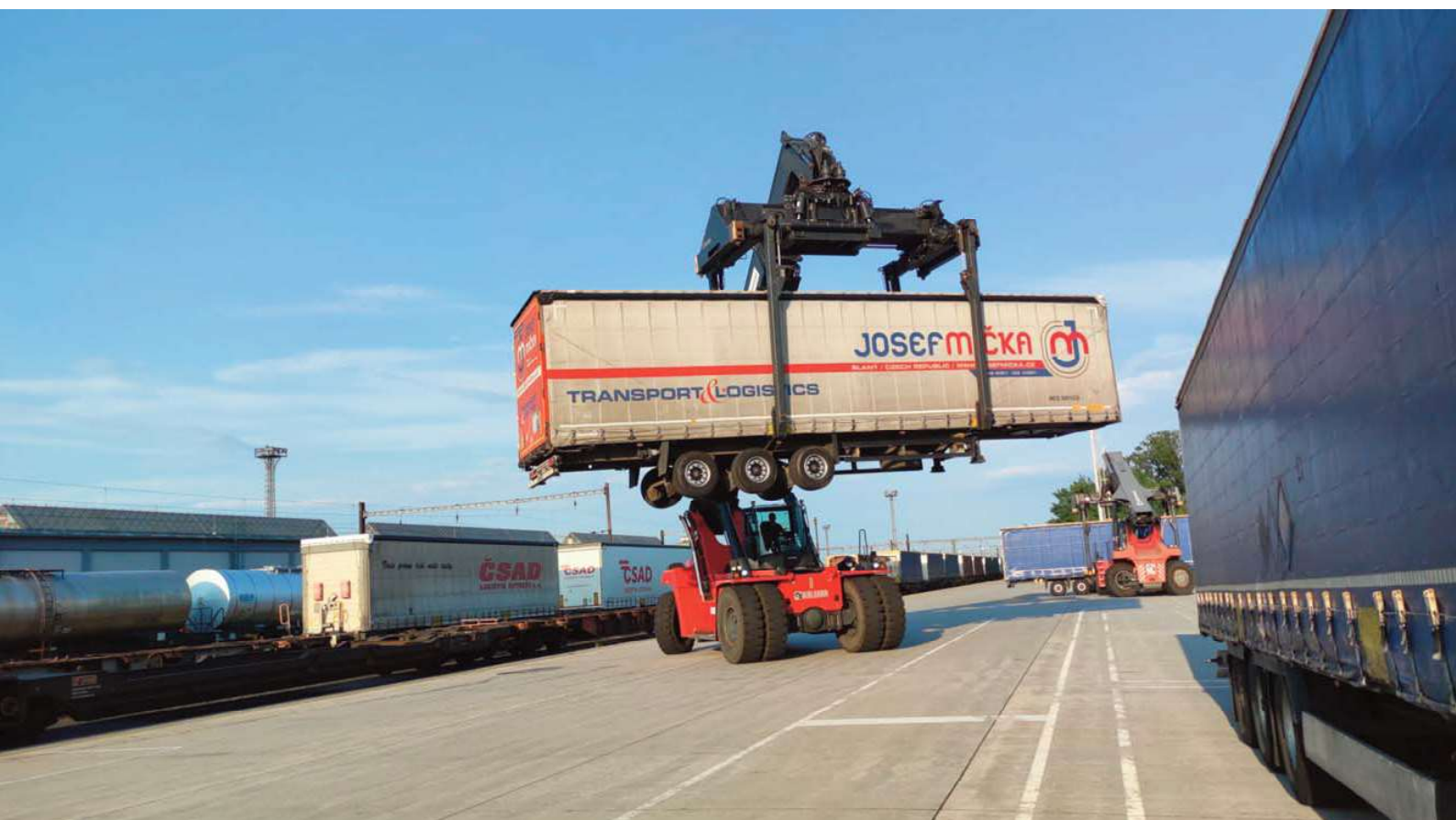
Nakládka intermodálního návěsu do kapsového vozu v terminálu ČD DUS Lovosice
