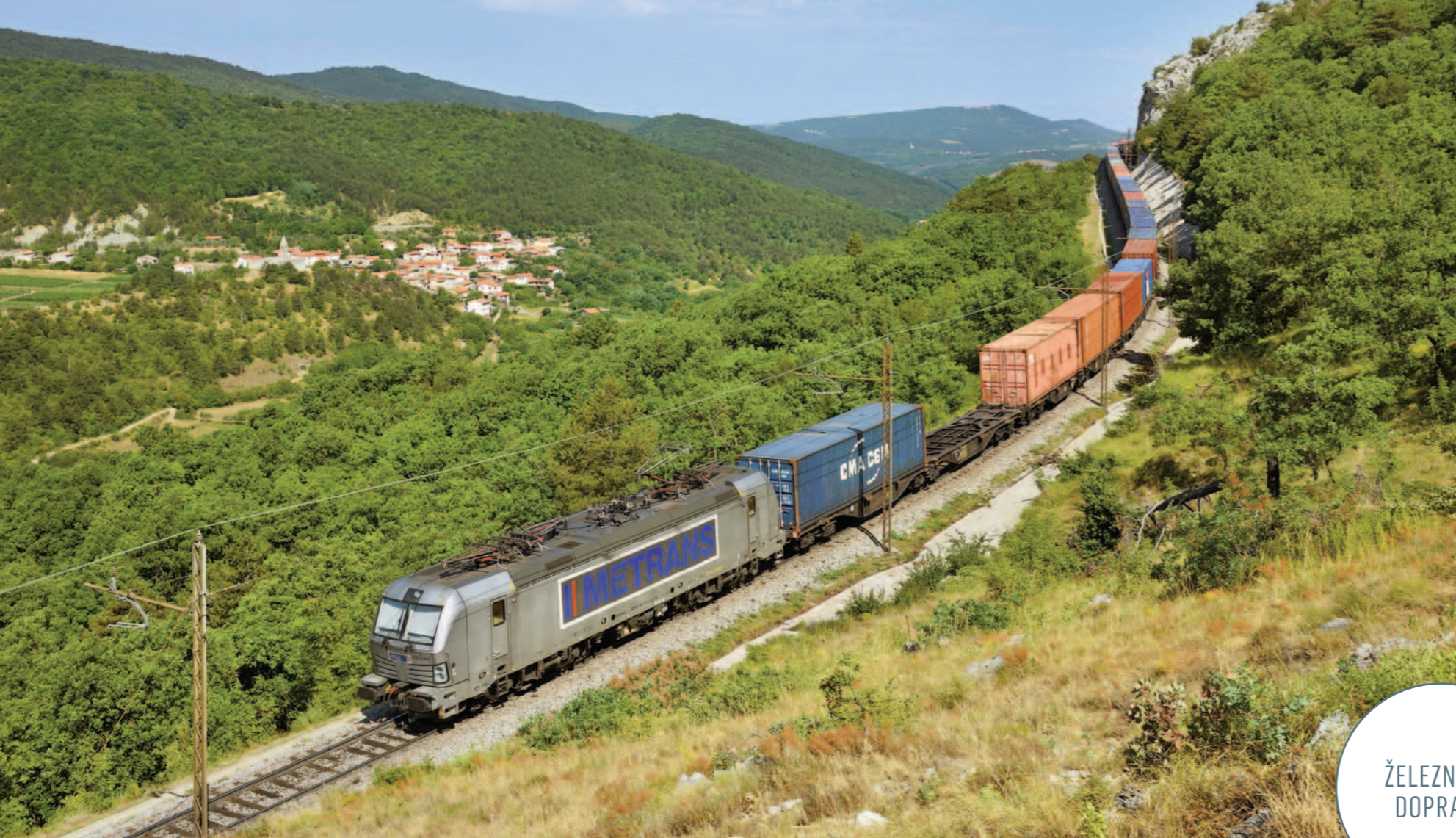
V čele nákladního vlaku lokomotiva Metransu Siemens Vectron vybavená ETCS.
